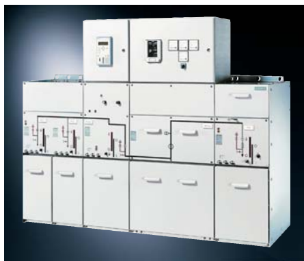
Quadro 8DH10 IAC A FLR 21kA 1s Esente da manutenzione
